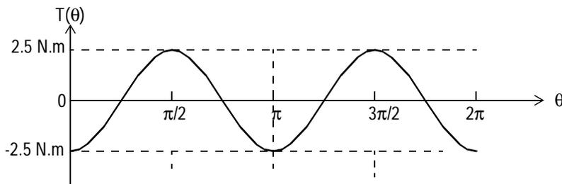
b) On fait circuler dans la bobine 1 un courant continu de 5 A et dans la bobine 2 un courant continu de 1.5 A.
