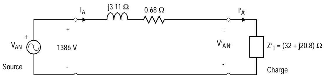
Courant de ligne au primaire:  $I_A = \frac{1386 \angle 0^\circ}{(0.68 + j3.11) + (32 + j20.8)} = 34.23 \angle -36.2^\circ \text{ A}$
