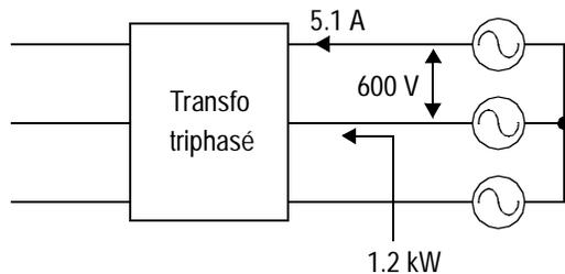
Les paramètres du transformateur sont calculés pour une phase.
