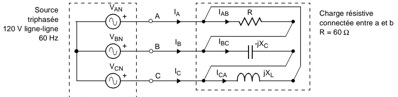
Dans ce montage,  $R$  est la charge résistive connectée entre  $a$  et  $b$ . Les réactances  $X_L$  et  $X_C$  ont été ajoutées afin d'équilibrer le système.
