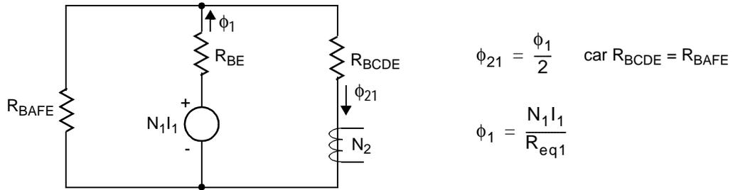
Le flux créé par la bobine 1 est  $\phi_1 = \frac{N_1 I_1}{R_{eq1}}$ , avec  $R_{eq1}$  = réluctance équivalente vue par la bobine 1.
