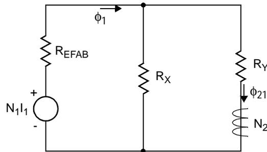
Le flux créé par la bobine 1 est  $\phi_1 = \frac{N_1 I_1}{R_{eq1}}$ , avec  $R_{eq1}$  = réluctance équivalente vue par la bobine 1 =
