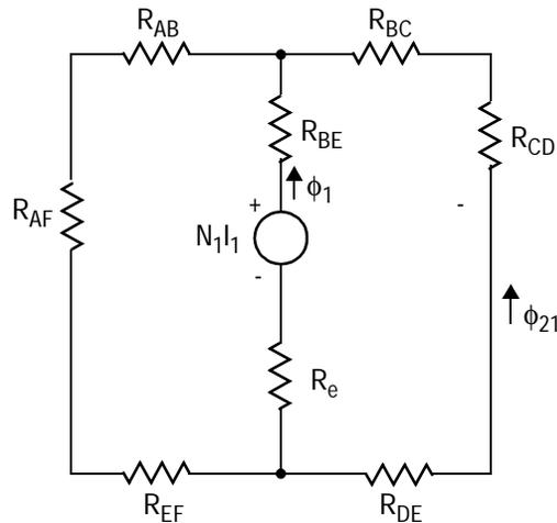
Le flux créé par la bobine 1 est  $\phi_1 = \frac{N_1 I_1}{R_{eq1}}$ , avec  $R_{eq1}$  = réductance équivalente vue par la bobine 1.
