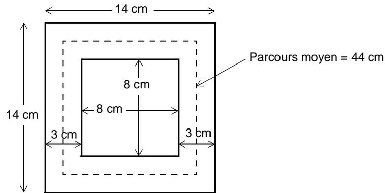
Le courant efficace est donné par:  $I_{\text{eff}} = \frac{V_{\text{eff}}}{120\pi \times L}$ , avec  $V_{\text{eff}} = 120 \text{ V}$ ,  $L = \text{inductance de la bobine} = 100 \text{ mH}$ .
