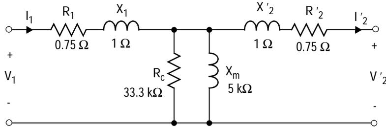
b) Circuit équivalent du transformateur référé au secondaire:
