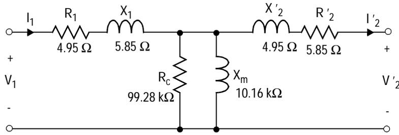
b) Une charge inductive  $(32+j25)\Omega$  est connectée au secondaire.
