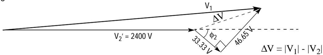
Le facteur de régulation maximal (le plus mauvais!) est obtenu lorsque la différence entre  $V_1$  et  $V_2'$  est maximale. Cette condition est illustrée dans le diagramme vectoriel suivant:
