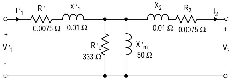
c) Le primaire est connecté à une source par une ligne de transport. Le secondaire est relié à une **charge nominale** (avec un facteur de puissance = 0.8 AR)
