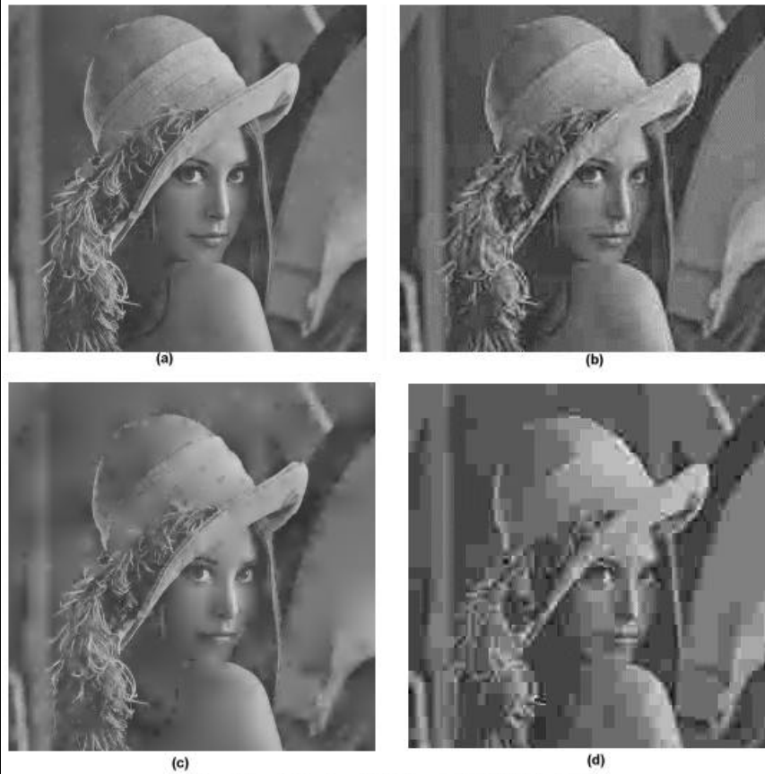
Figure5: Dégradation de "lena" par FMT (à gauche) et JPEG (à droite) FMT : pourcentage de coefficients éliminés: (a) 90%,(c)93%. JPEG: rapport de compression: (b)29:1,(d)48:1.
