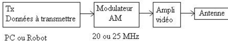
**Figure 20 : Schéma de transmission**
